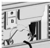
Модуль В должен быть надежно вставлен в корпус.
